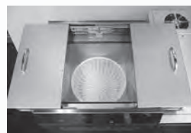
非破壊式放射能測定装置(内部)
